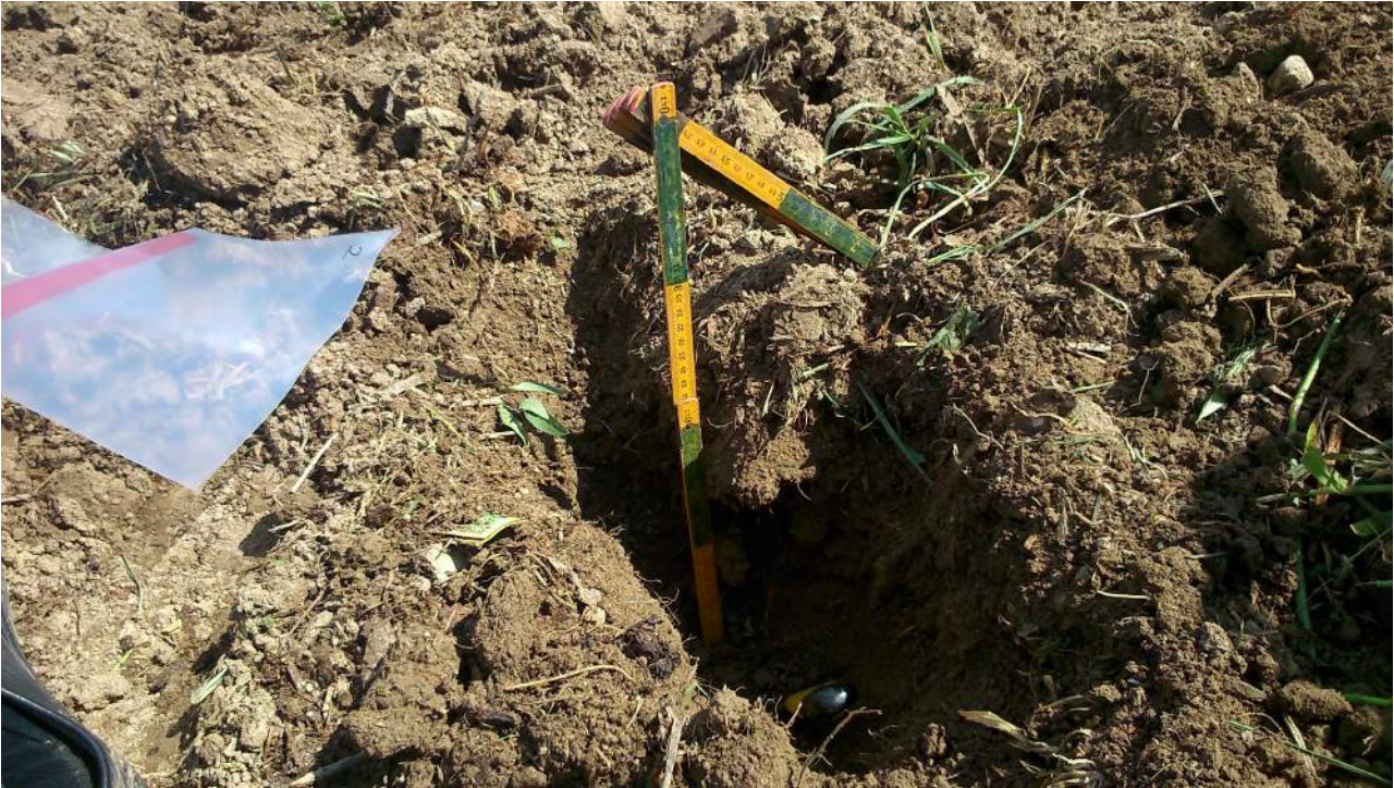
Fotografía 8: Método de toma de muestras de tierra.
